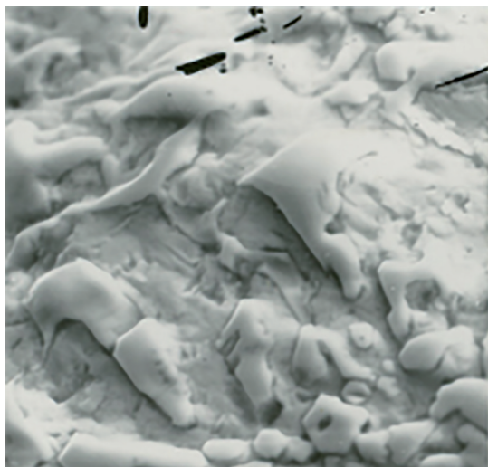
图6 边缘钝化表面微观结构
