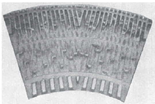
图1 磨片大面积断齿图
