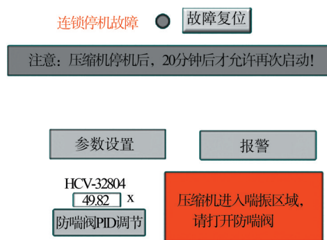
图6 蒸汽压缩机喘振时DCS报警画面
